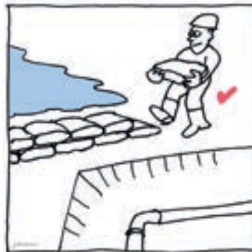
Ledningsnettet skal sikres mod overfladevand.
